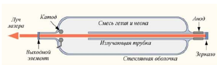
Рисунок 1 — Принцип действия газового лазера
