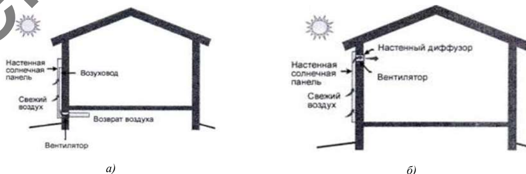
Рисунок 5 — Схемы использования воздушных коллекторов для отопления зданий
