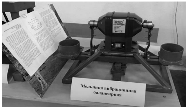
Рисунок 2. — Лабораторная установка вертикальной вибрационной мельницы
