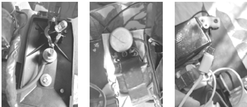
Рисунок 2 — Светодиодный индикатор, выпрямитель на основе диодного моста, кабель micro USB
