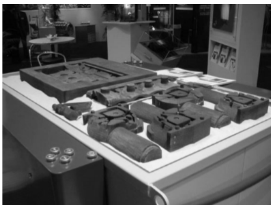
Рисунок 5 — Блок цилиндров (фрагменты песчаной формы)
