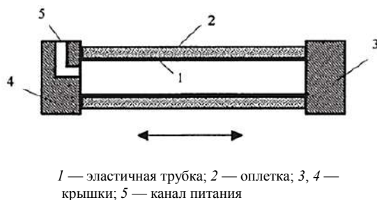
Рисунок 1 — Схема пневмомускула
