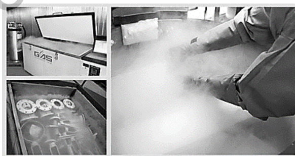
Рисунок 1 — Оборудование для криогенной обработки и процесс обработки
