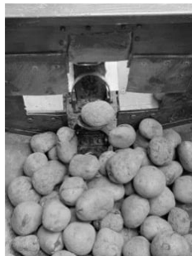
Рисунок 2 — Высаживающий аппарат роторно-ложечной картофелесажалки
