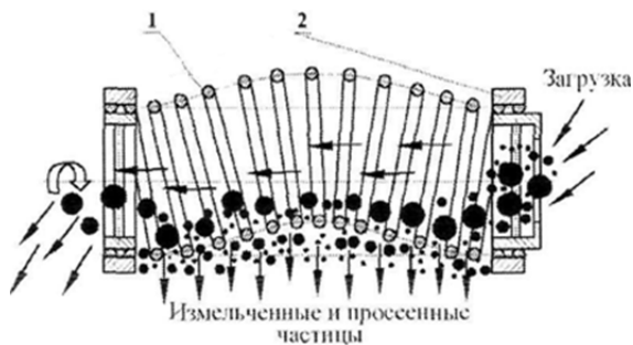
Рисунок 4 — Принцип работы пружинной мельницы
