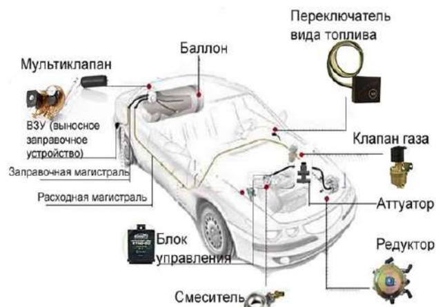
Рисунок 2 — Схема ГБО второго поколения
