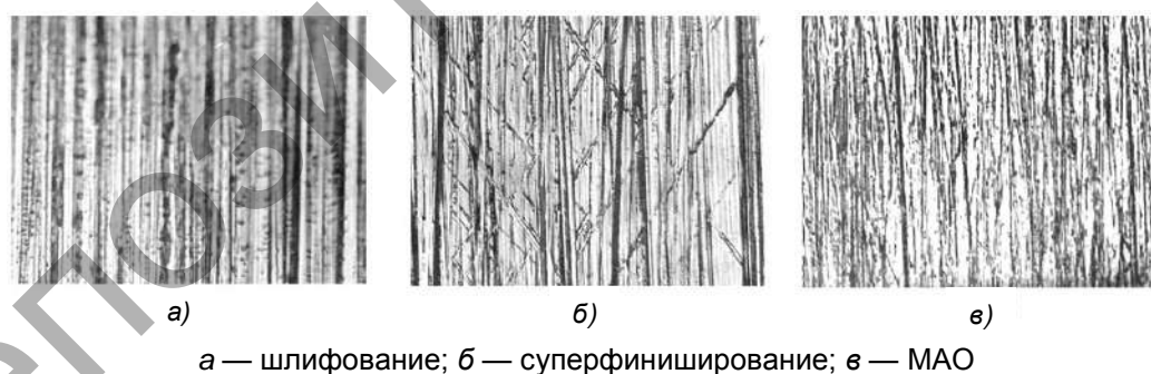
Рисунок 4. — Топография поверхности стали 12Х2Н4А после финишной обработки. \times 150
