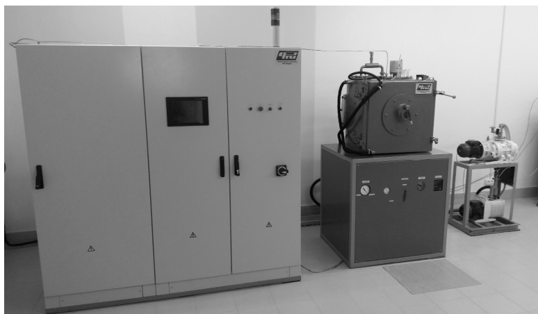
Рисунок 1 — Установка ионно-плазменного азотирования
