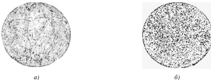
Рисунок 4.4 — Перлит: a — пластинчатый; б — зернистый
