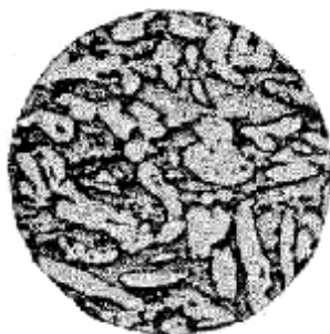
Рисунок 10.4 — Микроструктура литой двухфазной латуни Л62 (светлые зерна — \alpha -фаза, темный фон — \beta -фаза)
