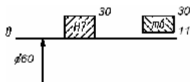
Рисунок 1.6 — Схема расположения полей допусков сопряжения \text{Ø}60 \text{ H}7/\text{m}6
