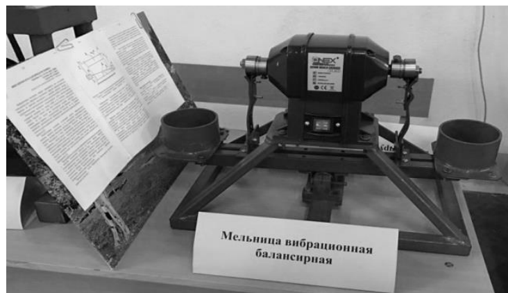
Рисунок 2. — Лабораторная установка вертикальной вибрационной мельницы
