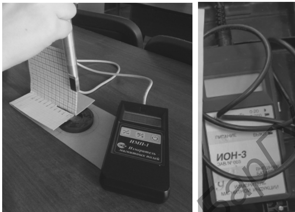
Рисунок 1. — Измерение магнитных полей с использованием пространственного координатора и магнитометров
