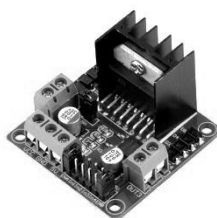
Рисунок 7 — Драйвер двигателя L298N
