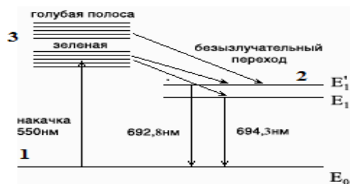
Рисунок 2 — Схема энергетических уровней иона хрома в рубине
