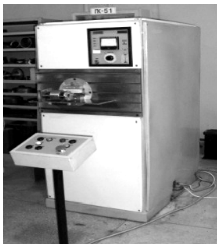
Рисунок 3 — Магнитно-импульсный пресс и отштампованные детали
