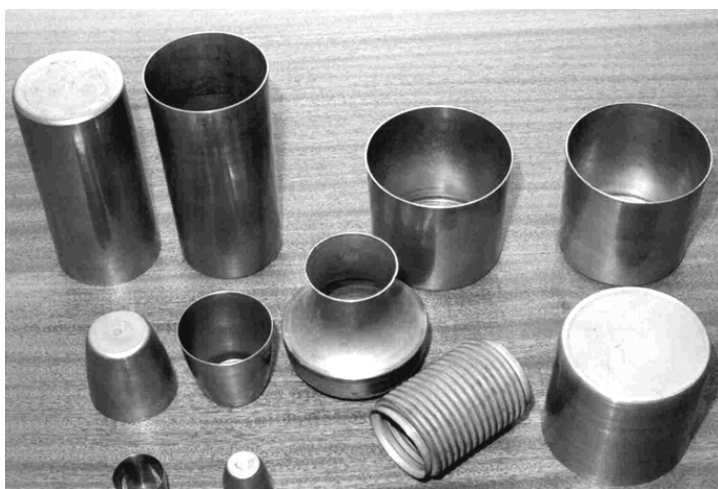
Рисунок 2 — Гидроударный пресс и отштампованные детали
