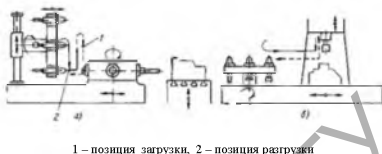
Рисунок 290 – Схема смены инструментов без применения загрузочных и транспортных устройств
