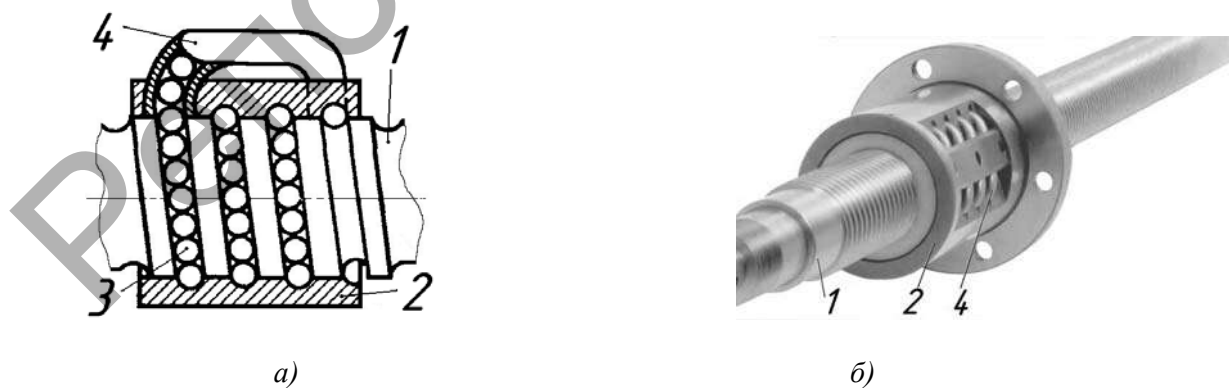
a — схема шариковой винтовой передачи; б — винтовая пара качения станка фирмы HAAS
