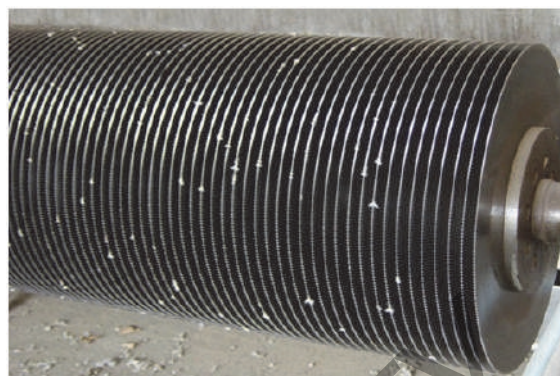
Рисунок 3. — Вал хлопкоочистительной машины с набором зубчатых дисков
