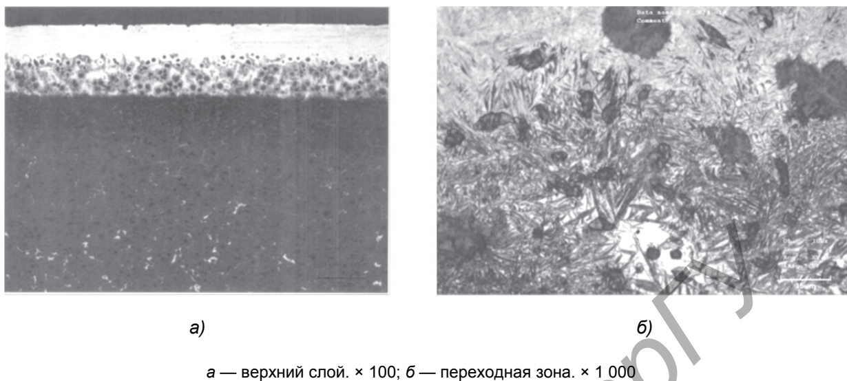
Рисунок 2. — Микроструктура зоны лазерного упрочнения бейнитного чугуна
