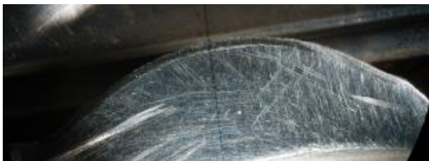
Рисунок 2 — Сферическая поверхность шарового пальца с покрытием
