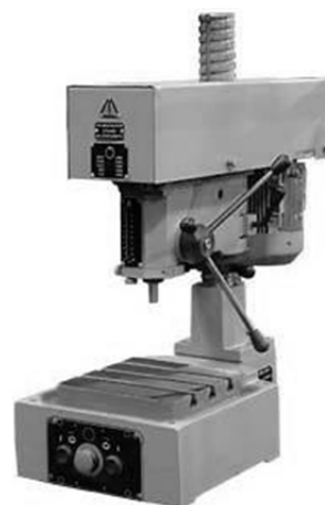
Рисунок 2 — Настольный вертикально-сверлильный станок модели 2М112
