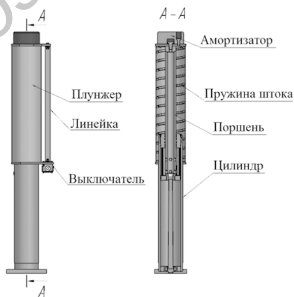
Рисунок 7. — Гидравлический буфер
