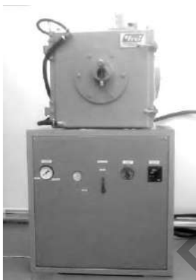
Рисунок 3.7 — Вакуумная камера установки, установленная на раме
