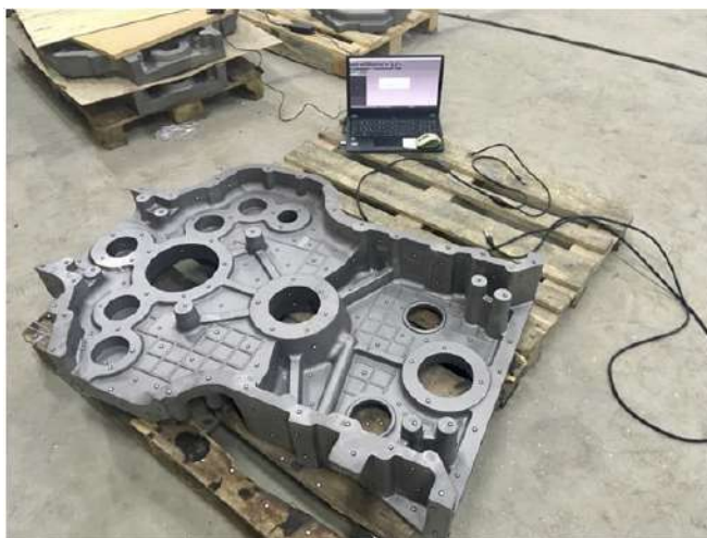
Рисунок 2 — Подготовка к процессу сканирования
