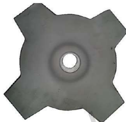
Рисунок 4 — Общий вид 4-х лопастного ножа для мотокосы после ИПА
